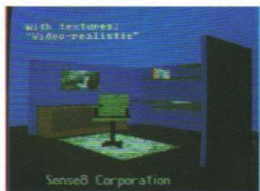
Il progetto IntelSense8 ha prodotto, con l'utilizzo di apparecchiature DVI, un sistema per circa 20 milioni di lire che oltre ad eseguire un rendering in tempo reale disegna, sempre in tempo reale, anche la trama delle superfici. Le immagini possono essere memorizzate come superfici e avvolte o poste sopra gli oggetti - guardate bene quel disegno e date un'occhiata al livello dei dettagli!
